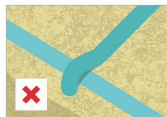
Отступ от края плиты не более 30 мм. Ширина полосы нанесения клей-пены 15-20 мм.
