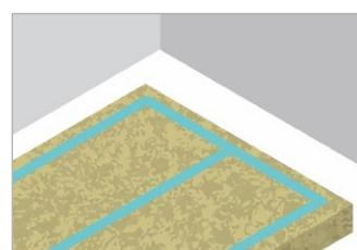
Основной kleевой слой необходимо наносить равномерно только на обратную сторону ленточным способом по периметру и полосой по центру. Стыковка полос осуществляется плотной, без наложения.
