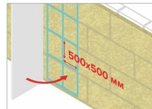
При двухслойной обшивке осуществляется разбежка швов ГКЛ/ГВЛ, для этого монтаж второго слоя начинают 1/2 листа с креплением второго слоя механически. Для предотвращения появления трещин в местах стыка листов обшивки применяется специальная армирующая лента.
