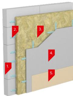
Применяется для выравнивания и улучшения звукоизоляции внутренних стен, межквартирных перегородок и иных конструкций, требующих дополнительной звукоизоляции. Система позволяет эффективно поглощать шумы, проходящие через конструкцию стены и увеличить звукоизолирующую способность существующей конструкции до 21 дБ.
